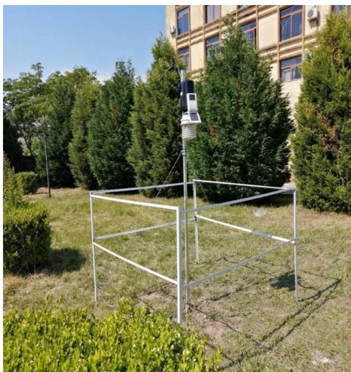
Figura 25: Stacioni meteorologjik i automatizuar në Shkodër
