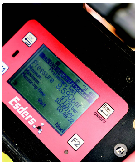
Pajisje për matjen e presionit, e përdorur për testimin e vazhdueshëm të të gjitha lidhjeve të rrjetit.
